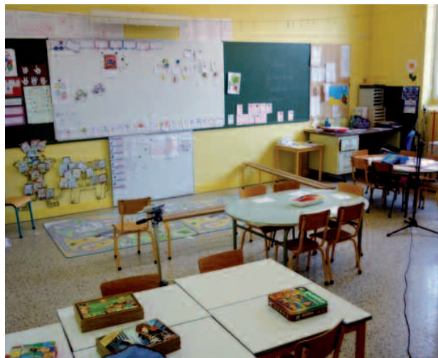
Vue générale de la salle de classe considérée pour la mesure. On peut constater le microphone de mesure localisé à 4 mètres de la chaise du professeur.
